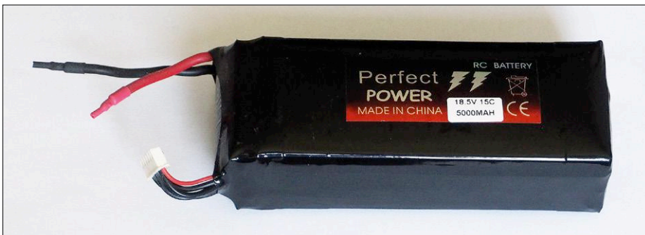
Figuur 4. Lithium-polymeer-accu van het type 5s1p met 18,5 V bij 5 Ah en een piek-ontladingstroom van 15 C = 75 A voor RC-modellen. De kleine zespolige stekker is voor het aansluiten van een balancer.
